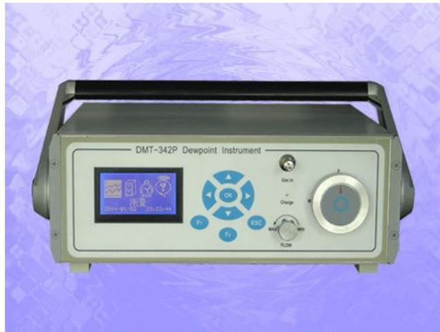
自恢复保持湿端的稳定从而保证测量曲线与理论曲线的吻合。另外探头自动加热。此功能用于自动校准抗结露(高于环境温度 10 度), 抗油污(加热至+300℃, 用于瞬间蒸发聚合在探头表面的各种油污)。DMT242 专门设计适合极端恶劣的环境, 且防污染, 防水, 防尘。
